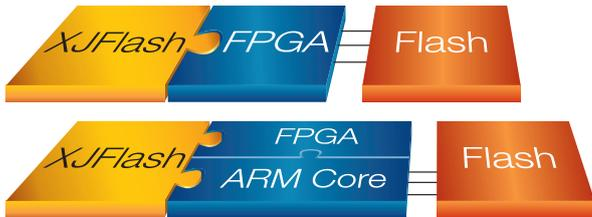
Der Flash ist direkt mit dem FPGA verbunden.
